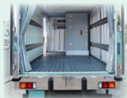
二基の冷凍機を設置した二層式車両を採用し、前室、後室それぞれフローズン仕様にするにより、後室作業時の前室への温度上昇の影響を防いでおります。
